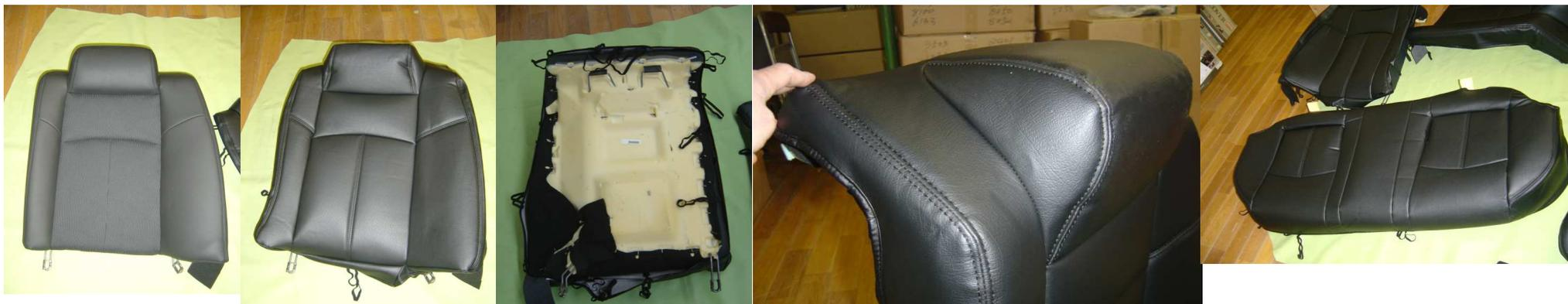
カバーをかぶせて全体のバランスを取りながら、ゴムの引っ張り具合を加減して下さい。ヘッドレストや肩口のラインは特にタイトな形状ですので、十分に生地をもみ込みながら、シワを取って下さい。※車体に戻してからの調整は難しいので、この段階で仕上げて下さい。
