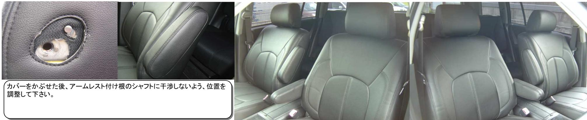
カバーをかぶせた後、アームレスト付け根のシャフトに干渉しないよう、位置を調整して下さい。
